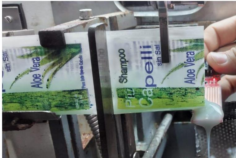
**Figura #26:** Demostración de derrame en sensor detector de líquidos.
