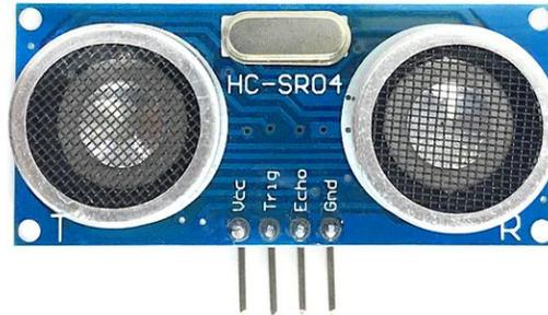
**Figura #2:** Sensor de Ultrasonido utilizado en el presente proyecto, modelo SR04.
