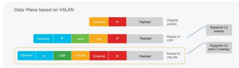
Figura 5. Plano de datos del Fabric basado en VXLAN
