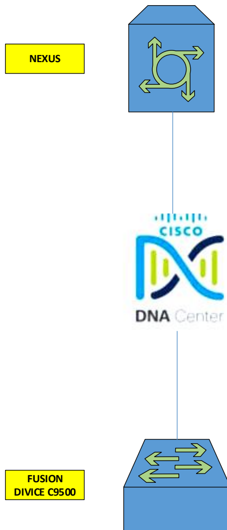
Figura 11. Topología e Interconexiones DNA Center
