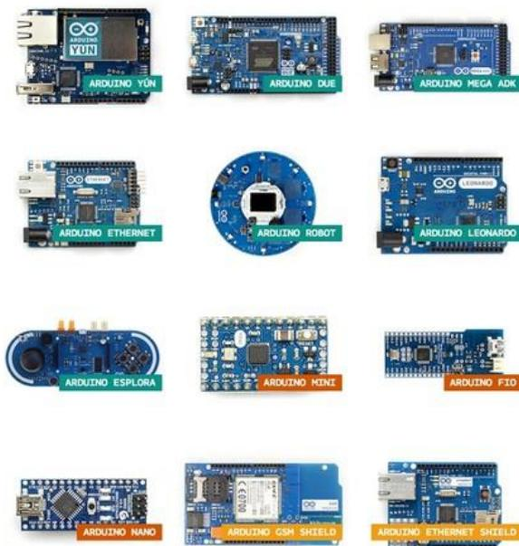
**Figura 10.** Tipos de placa Arduino.
