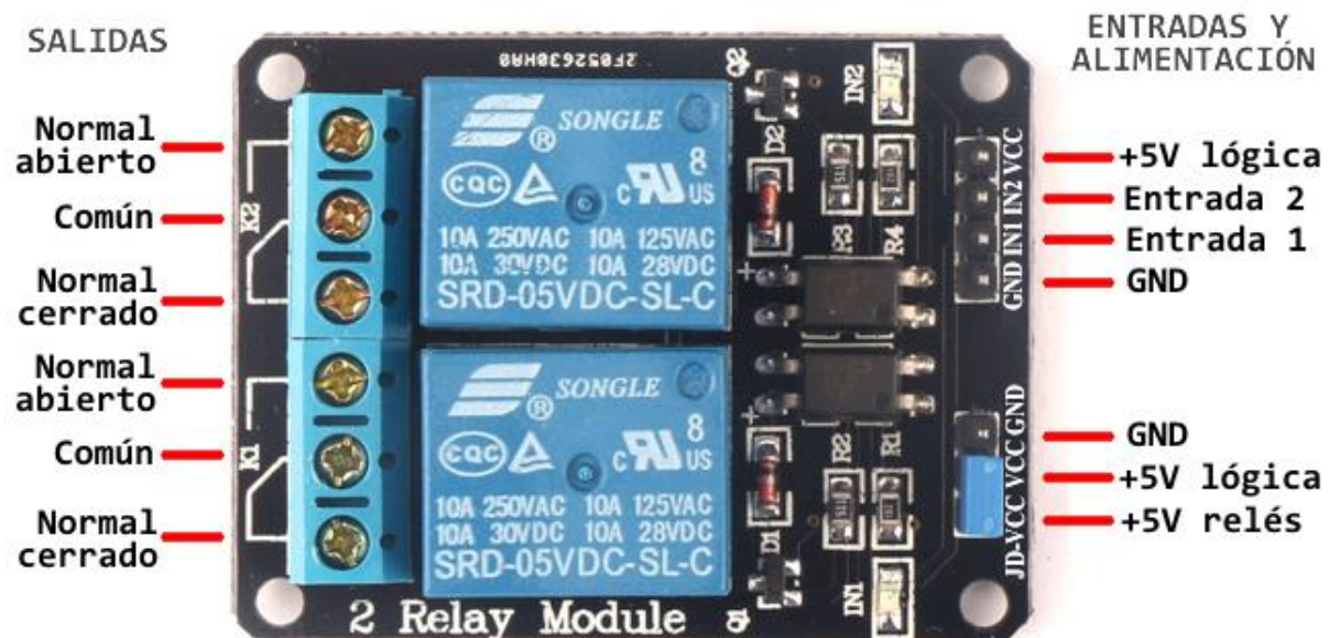
Ilustración 9. Conexiones del módulo de relé
