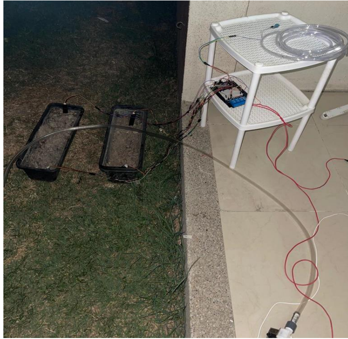
Foto 3. Prueba de relé de energía, válvula y comando por voz
