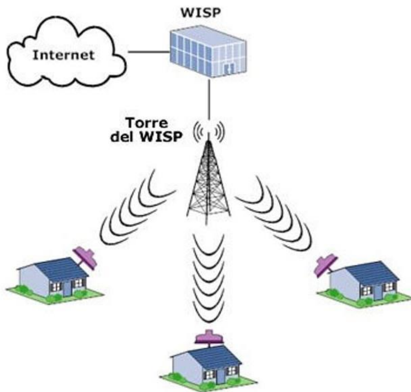
Figura 54 WISP me mediante radio enlace Punto a Multipunto
