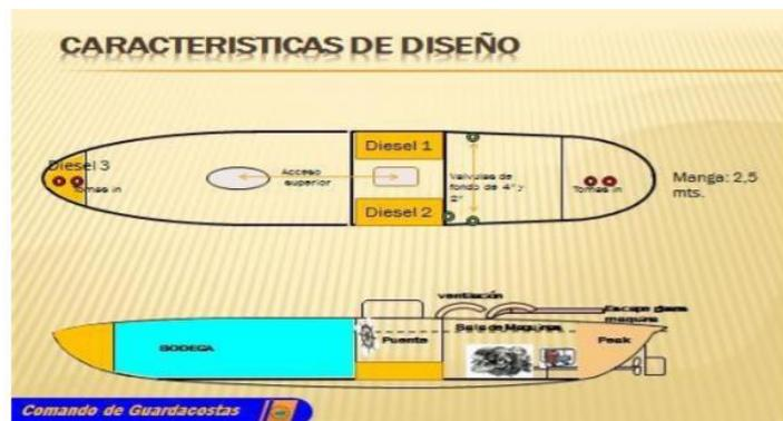
Ilustración 3 Características de un sumergible
