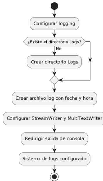
Diagrama de flujo para configuración del sistema de logs en F#
