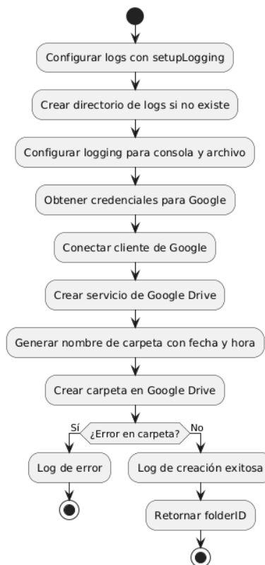
Diagrama de flujo de la configuración y autenticación en GO
