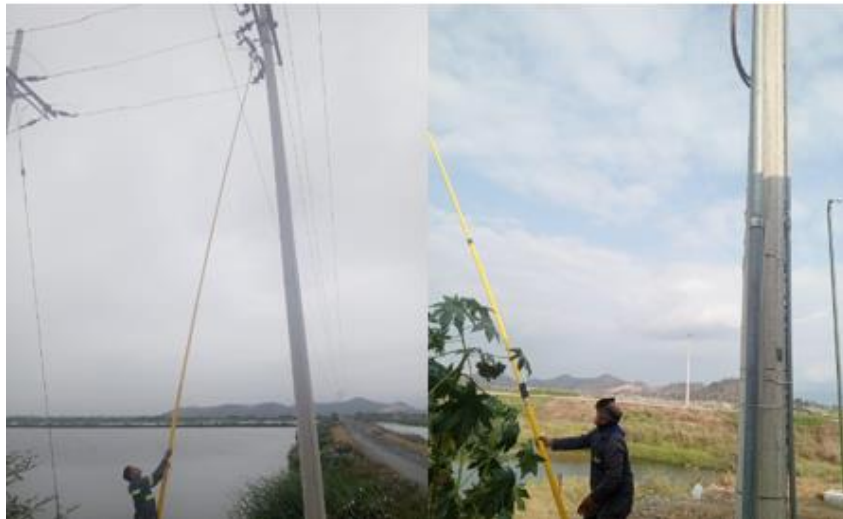
Figura 36. Medidor de media tensión para comprobación de fluido de energía en postes. Fuente propia.
