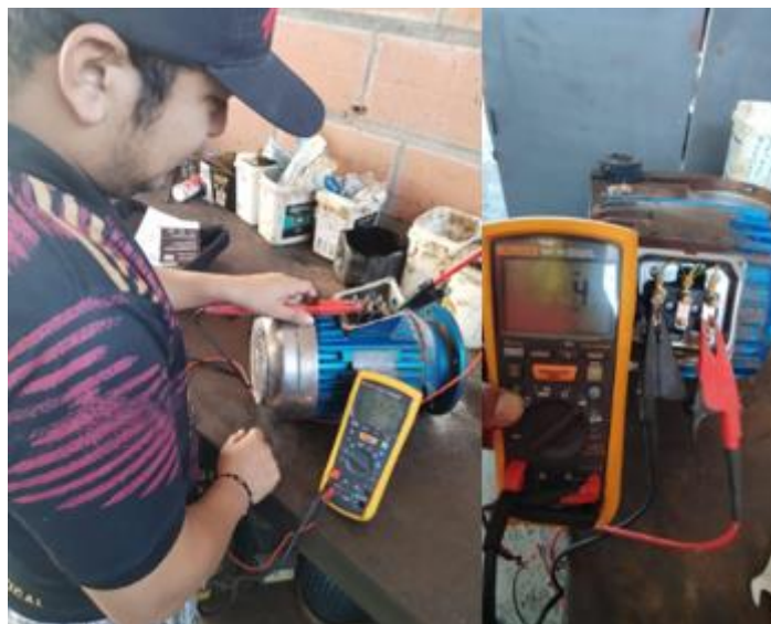
Figura 34. Megger para medir aislamiento en motores eléctricos reductores. Fuente propia.
