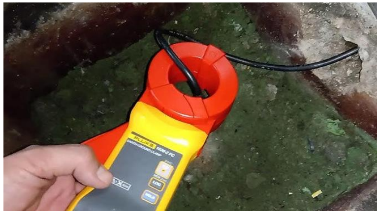
Figura 36. Medidor de media tensión para comprobación de fluido de energía en postes. Fuente propia.
