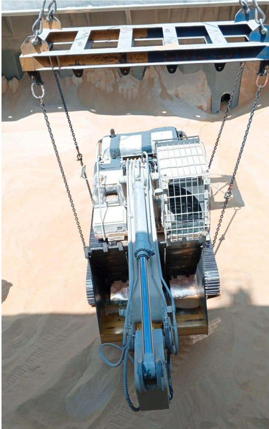
Anexo 6. Proceso de maquinaria introducida en el buque para arrume de carga mediante un Spreader
