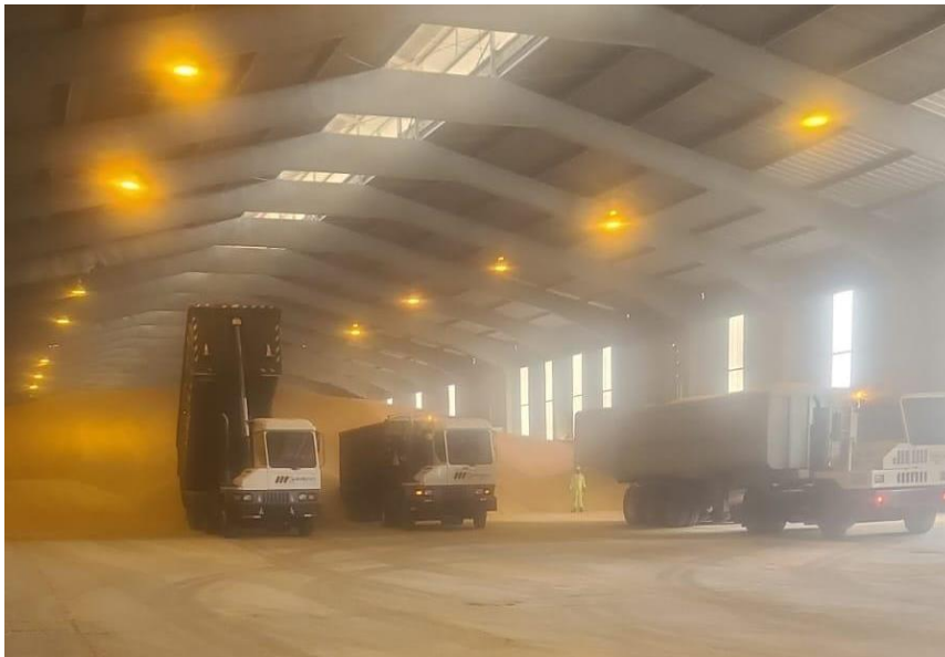
Anexo 9. Proceso de descarga de carga granel en almacenamiento
