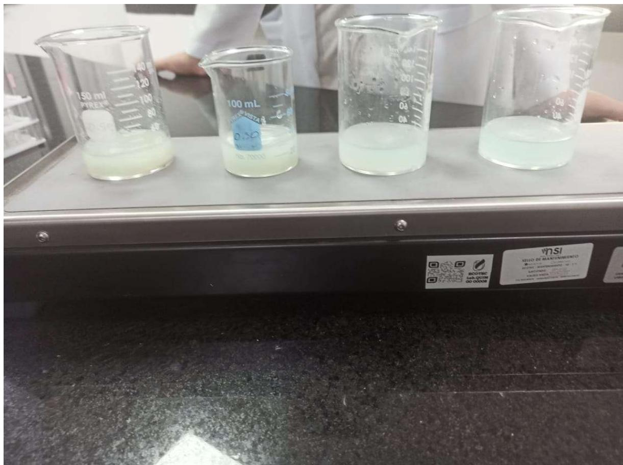
**Figura 8.** Proceso de adsorción de azul metileno con distintas concentraciones de sílice.
