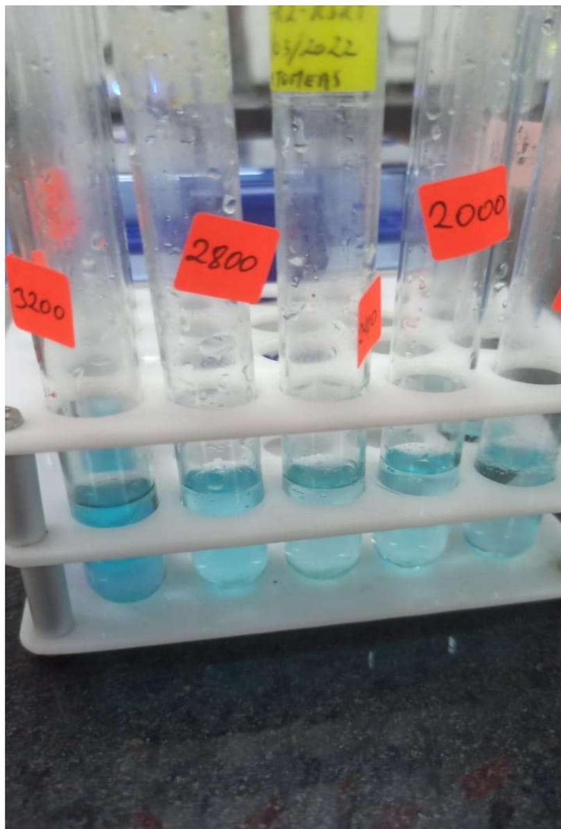
**Figura 7.** Muestras con distintas concentraciones de azul metileno para crear la curva de nivel en el cromatógrafo
