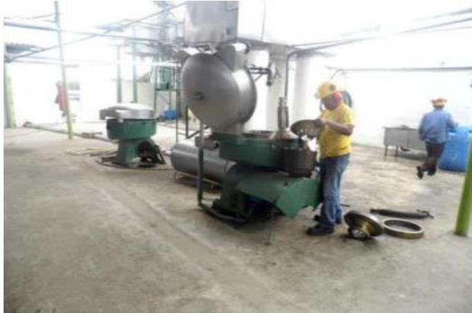
Figura 8. Centrífuga para la extracción de aceite de pescado
