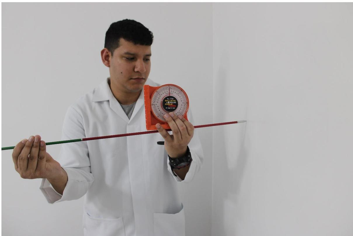
*FOTO 3. Proceso de toma de medidas con el uso de kit de herramientas para trayectorias balística.*
