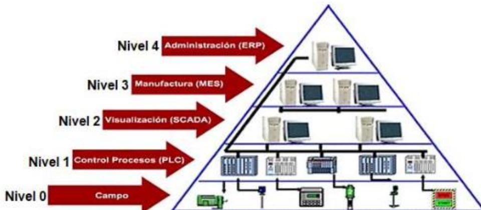
*Nota.* El gráfico representa cada uno de los niveles del proceso de automatización. Tomado de Automatización de procesos industriales mediante Industria 4.0. Tomado de Lozano y Zamora (2008), (p.102) por Barona y Velastegui (2021)
