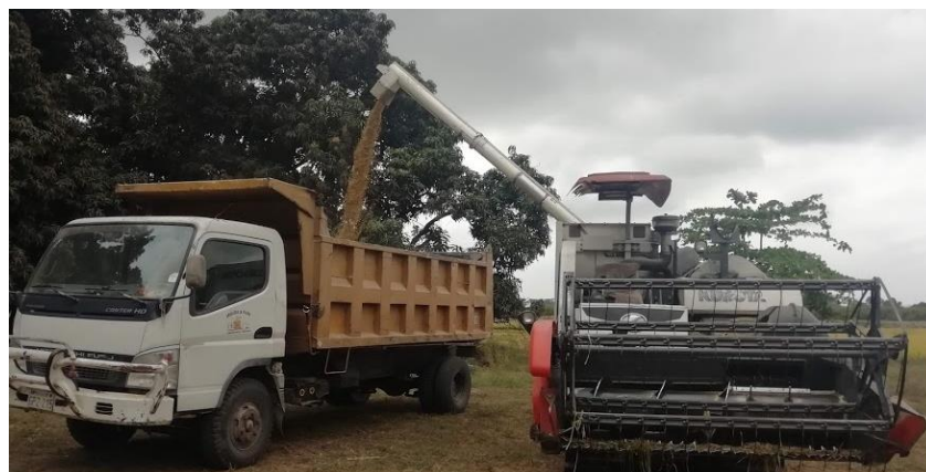
Ilustración 15. La máquina cosechadora expulsa el arroz para luego ser transportado a un centro de acopio Elaboración propia
